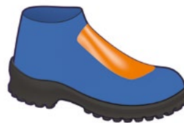
■ Figure 12. La protection du métatarse
